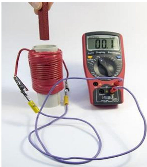
Fig. 10.12 Dispozitiv pentru evidențierea fenomenului de inducție electromagnetică
