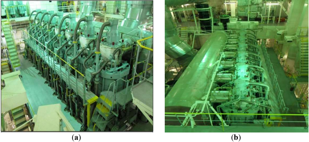
Figura 3.1 Motorul principal al navei VLCC: (a) vedere laterală; (b) vedere de sus. [foto reală de la bordul navei]
