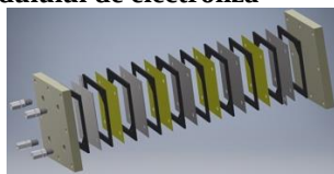
Fig. 31. Ansamblu electrozi – diafragma (vedere explodată)
