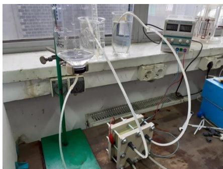
Fig. 37. Imagine a modulului de electrolizor ansamblat cu 5 celule pe baza de SOE, conectate in serie, cu electrozi bipolari – in timpul testelor de functionare
