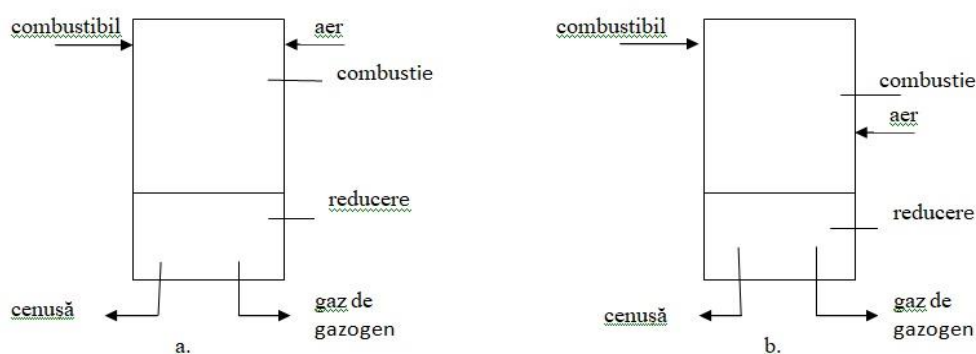
Fig 12. Schema gazeificării în strat fix: a) – echicurent; b) – contracurent
