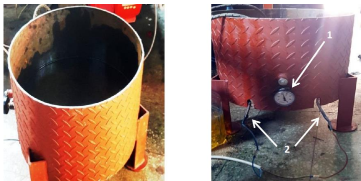
Fig. 6. Vasul pentru încălzirea mixturii (1-termometru, 2-rezistența electrică)
