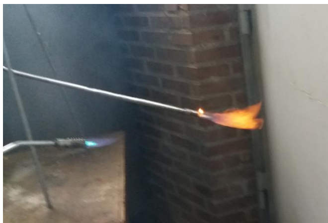
Fig. 14. Evacuarea gazului de gazogen pentru experimentul cu lemnul uscat
