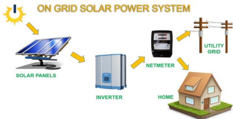
Figura 13. Sistem fotovoltaic conectat la rețeaua electrică.
