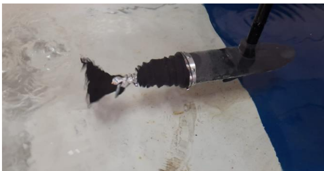
Fig. 4.9. Măsurare a mărimilor caracteristice a propulsoarelor navale neconvenționale
