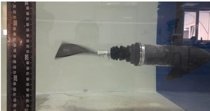
Fig. 4.12. Măsurarea amplitudinilor de mișcare pala_z (test 3)
